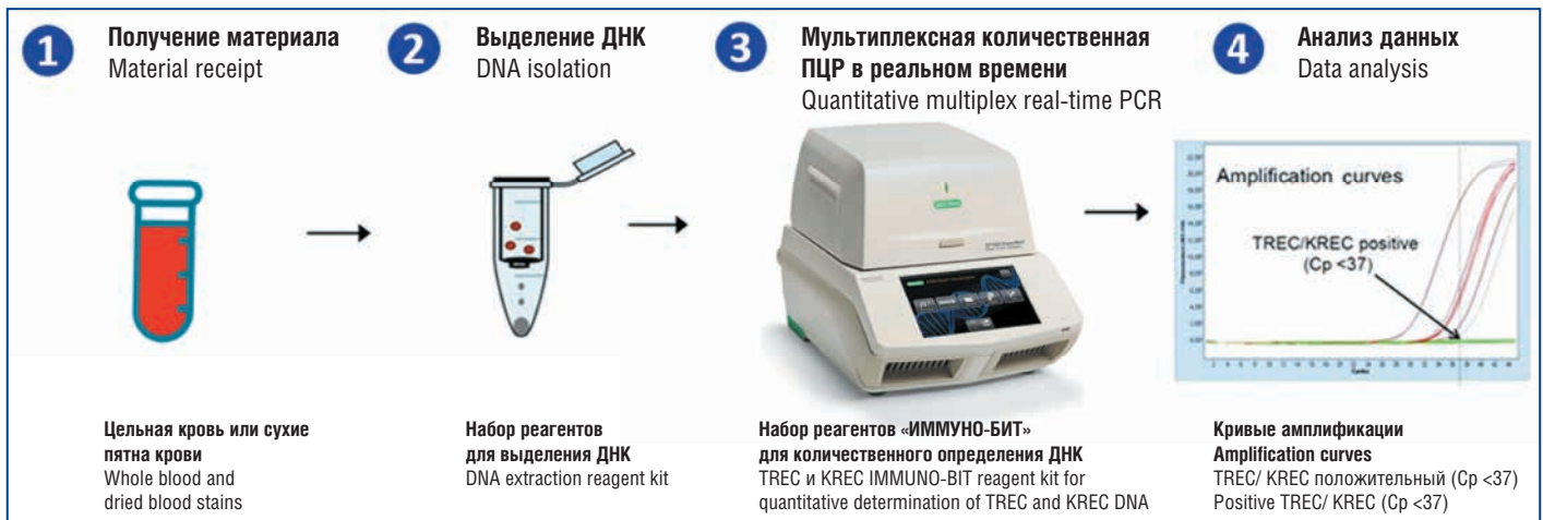
Рисунок. Краткая схема количественного определения ДНК TREC и KREC методом мультиплексной ПЦР в реальном времени
