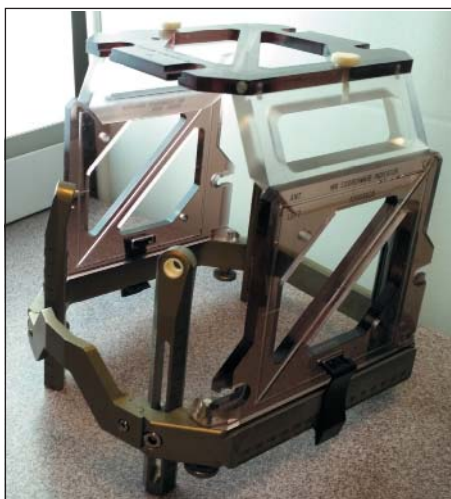
Рис. 3. МР-координирующий локалайзер с системой каналов, заполненных медным купоросом, фиксированный к координирующей раме
